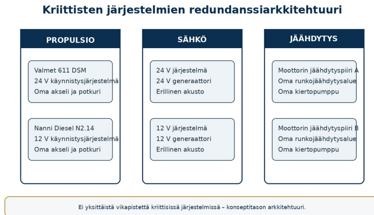
Kuva 1. Kriittisten järjestelmien redundanttisuusarkkitehtuuri konseptitasolla.
